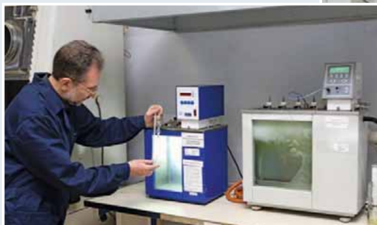
Подготовка к измерению вязкости дизельного топлива
